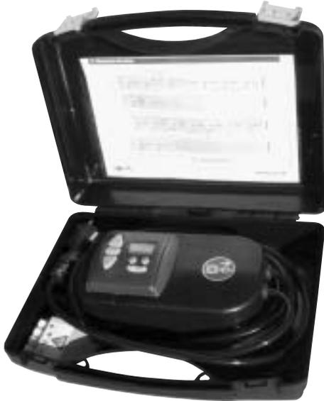
**Setting Tool WT** ist ein Einstellwerkzeug zur geführten Benutzung elektronischer Somfy Einsteckantriebe wie Orea WT und Oximo WT.
