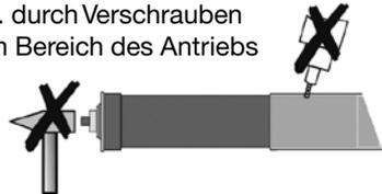
6. Die Welle mit dem Antrieb und der Wellenkapsel in den Lagern befestigen. Die Motorleitung und die Antenne nicht knicken und so verlegen, dass keine Schäden an Leitung oder Antenne entstehen können. Die Antenne nicht parallel zur Motorleitung legen. Die Antenne darf nicht gekürzt oder verlängert werden. Um zu verhindern, dass Wasser in den Motor läuft, die Motorleitung in einem Bogen nach unten verlegen, damit Fließwasser abtropfen kann.
