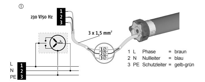
Hinweis: Schließen Sie immer nur den zu programmierenden Oximo RTS an die Netzspannung an! Der Oximo RTS kann nur eingebaut in der Welle programmiert werden.
