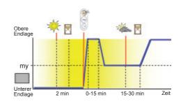
Der am Sonnensensor eingestellte Schwellenwert wird unterschritten.
