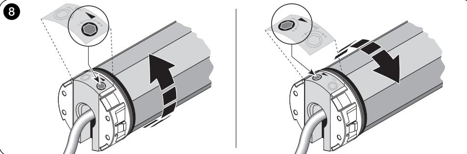
Regulacja ograniczników "0" i "1" (rys. 7) jest ręcznym rodzajem regulacji, umożliwiającym ustawienie wybranych położeń poprzez dokręcenie wkrętów regulacyjnych (rys. 8).
