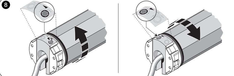
gestellten Endanschlägen (einige Umdrehungen der Antriebswelle nach rechts und nach links). Wenn diese Positionen persönlich abgestimmt werden sollen, die folgenden Verfahren durchführen.
