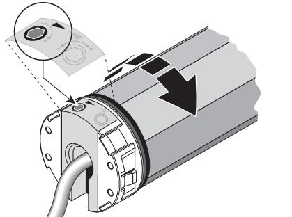
Tourner ensuite la vis de réglage (identifiée précédemment) de quelques tours, dans le sens du signe « - » et commander de nouveau la manœuvre vers la position « 0 » jusqu'à ce que le moteur s'arrête tout seul peu avant la position « 0 » .
