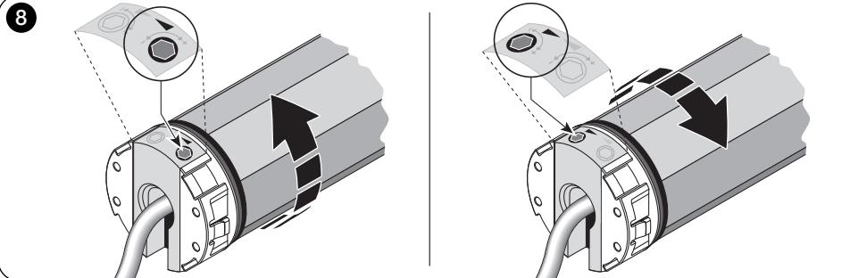
Le réglage des fins de course « 0 » et « 1 » (fig. 7) est de type manuel et permet de chercher les positions désirées en agissant sur les vis de réglage (fig. 8).
