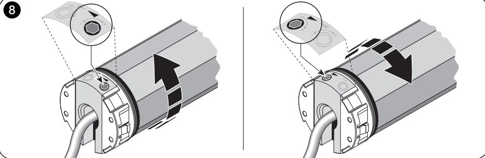
De afstelling van de eindschakelaars "0" en "1" (**afb. 7**) is van het handmatige type en maakt het mogelijk de gewenste posities te zoeken door aan de stelschroeven te draaien (**afb. 8**).
