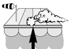
Wenn die Windgeschwindigkeit den am **☁ Wind** eingestellten Wert übersteigt, fährt der Behang ein. In diesem Zustand wird jeder manuell gegebene Fahrbefehl und jeder Sonnenautomatik-Fahrbefehl unterbunden.
