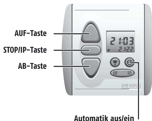
Die Automatik zum Öffnen bzw. Schließen des Behangs kann über einen Tastendruck ein- bzw. ausgeschaltet werden.
