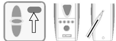
→ **Der Empfänger bestätigt mit 8 kurzen BIP-Tönen, daß der Code des zu löschende Sender korrekt aus dem Speicher des Empfängers gelöscht wurde.**
