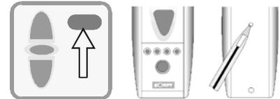
→ Der Empfänger bestätigt mit 8 kurzen BIP-Tönen das korrekte Einlernen des Senders.
